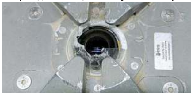
Повреждение защитного купола камеры
